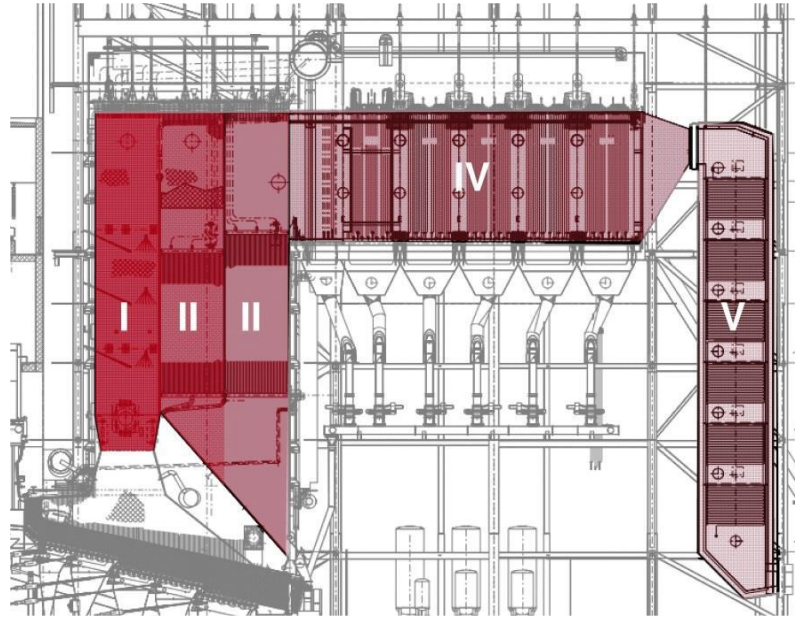
2 pav. Mišraus tipo atliekų garo katilas
